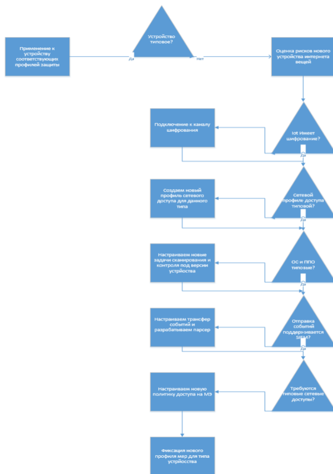
Рис. 2. Методика внедрения устройства Интернета вещей.
